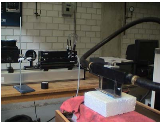
Figura 8. Láser y cavidad montados
