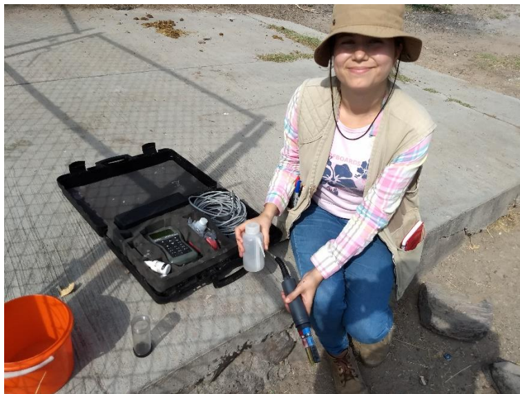
Fig. 3.5. Mediciones en campo con medidor multiparamétrico HANNA HI 9828 (Jun 2018).
