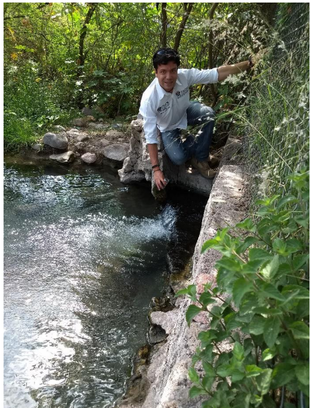
Fig. 3.1. Trabajo de campo con el Ing. Arias Paz, medición de profundidad de nivel estático y toma de muestra de manantial (Jun – 2018).
