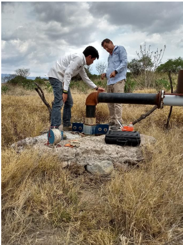
Fig. 3.1. Trabajo de campo con el Ing. Arias Paz, medición de profundidad de nivel estático y toma de muestra de manantial (Jun – 2018).
