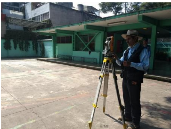
Figura 3.17. Establecimiento de vertice para toma de datos del perímetro del inmueble. (GACONSA, 2018)
