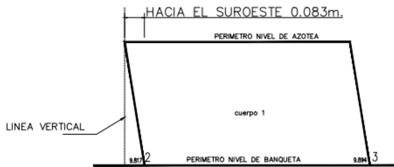
Figura 3.16. Vista lateral del edificio con inclinación al noreste. (GACONSA, 2018)
