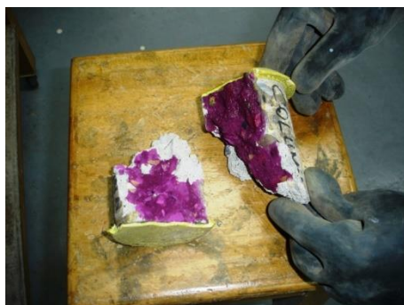
Figura 2.45. Prueba de Carbonatación con fenolftaleína en probeta de concreto. (Osorio, 2012)
