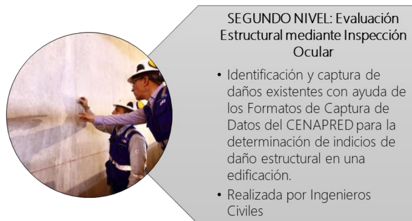
Figura 2.2. Niveles de Evaluación Estructural: Segundo Nivel
