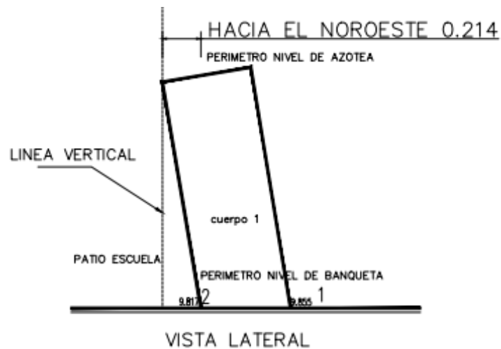
Figura 3.15. Vista lateral del edificio con inclinación al noreste. (GACONSA, 2018)
