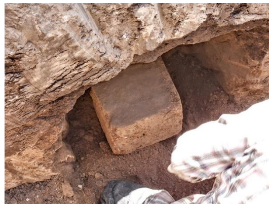
Figura 2.59. Extracción de muestra cubica inalterada de PCA. (RL Ingeniería, 2019)
