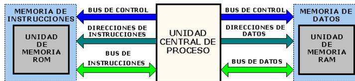
Figura 1.1: Arquitectura general de un microcontrolador [30].
