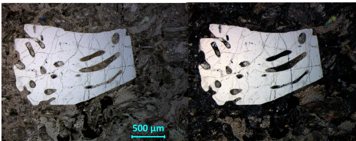
Figura 122. Cuarzo fuertemente fracturado con bahías. Aumento 5x, LPNA y LPA.
