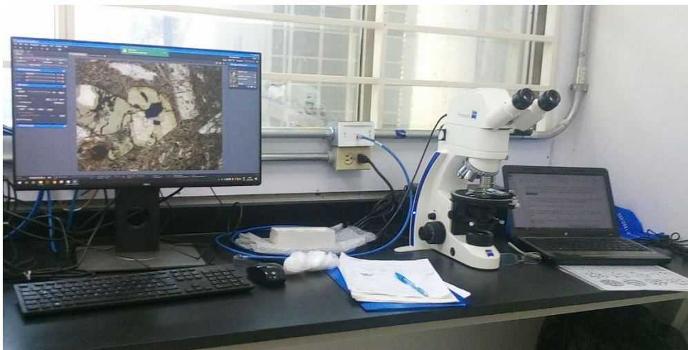
Figura 9. Microscopio Zeiss y software Zen que se utilizó para la toma de fotografías de las láminas delgadas.
