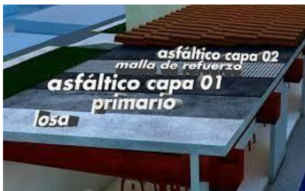
Figura 2.3- Sistema de impermeabilizante de capas alternadas
