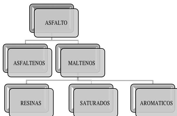
Figura 1.2.- Componentes del asfalto
