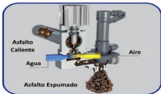
Figura 3.9.- Obtención del asfalto espumado
