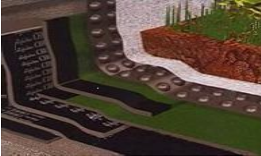
Figura 2.5.- Sistema de impermeabilización de azoteas verdes
