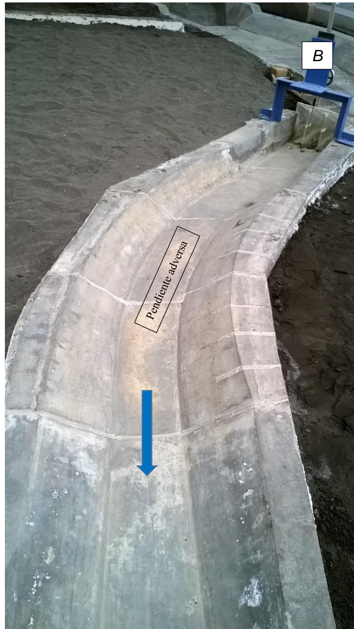
Fotografía 1.8 Curva horizontal con pendiente adversa en la plantilla
