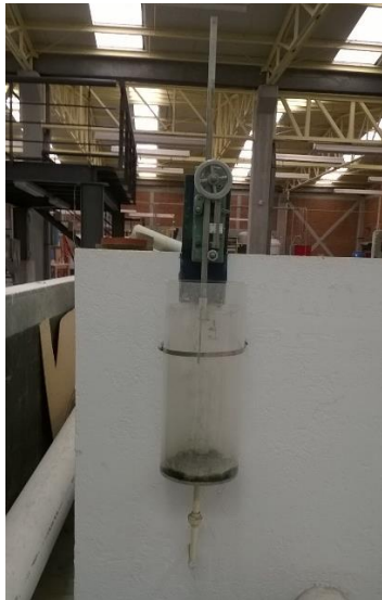
Fotografía 1.13 Limnómetro empleado para aforar el caudal
