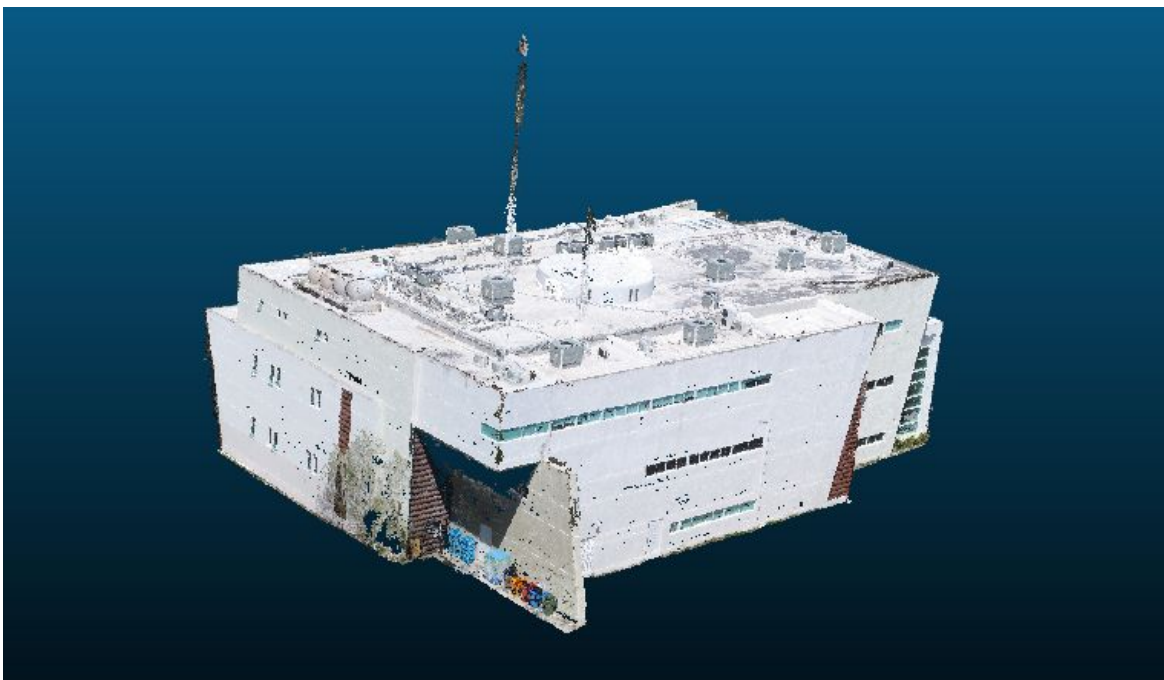
Figuras 2.5a y 2.5b. Segmentación manual de la nube de puntos de las instalaciones de CentroGeo Unidad Mérida, Yucatán, México. Realizada en el software libre CloudCompare . Obtenida a partir de un Vuelo Circular realizado con un VANT DJI Phantom 4 Advanced. Febrero 2019.
