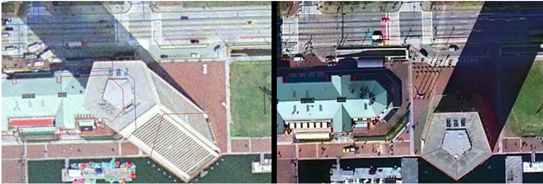
Figura 1.8. Comparación entre una fotografía aérea y una ortofoto. Fuente: Image Data Products del Colegio de Ciencias de la Tierra y Minerales de la Universidad Estatal de Pensilvania (Penn State).
