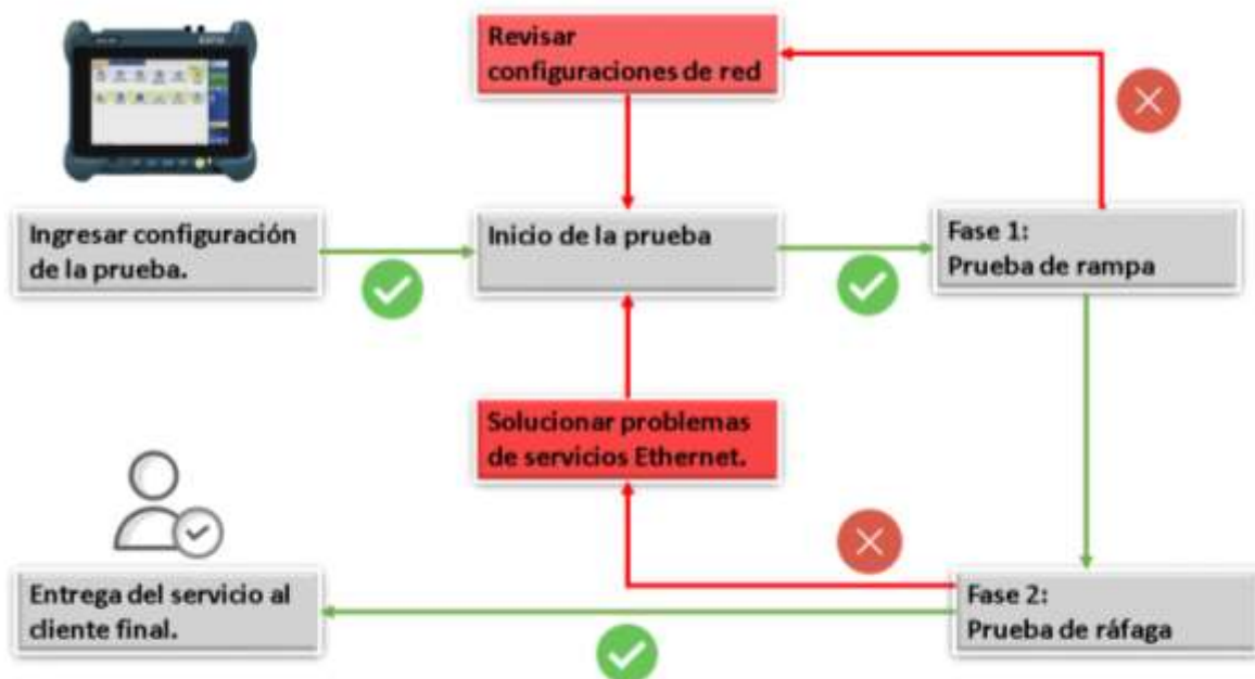
Figura 3. 5. Metodología de prueba de activación de servicios Ethernet.
