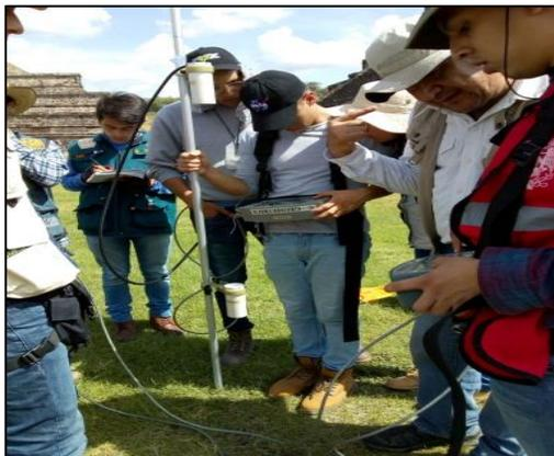
Figura 11. Magnetómetro G-858 MagMapper de Geometrics.
