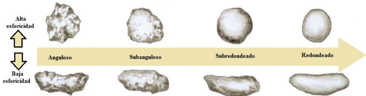
Figura 22. Redondez en las partículas cuando tienen alta o baja esfericidad (tomado de Freile, 2018)
