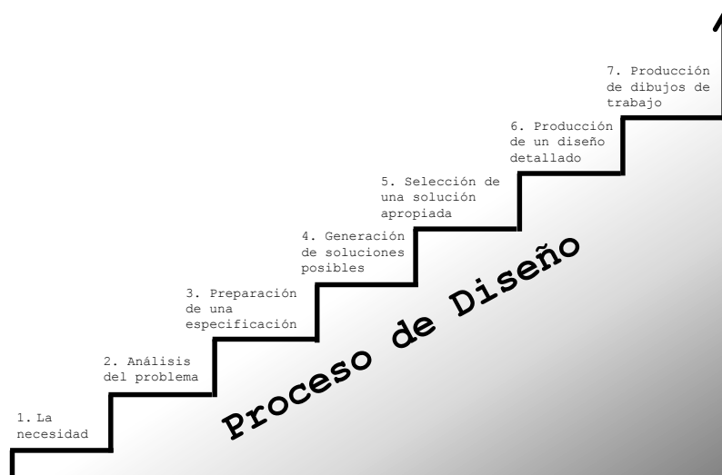
Figura A- 1 Etapas generales del proceso de diseño [7].
