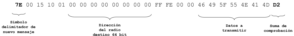
Figura 3-17 Ejemplo de una trama Xbee en modo API .
