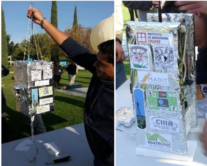
**Figura 1.13 - Carga antes del lanzamiento.** Plataforma CSM con clientes científicos a bordo, previo al lanzamiento del 26 de noviembre de 2016. [12]. Se observa la protección térmica y logos de entidades participantes.
