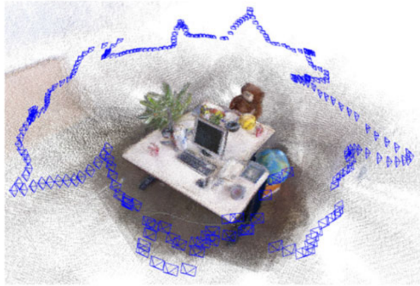
Figura 2.9: Reconstrucción semi-densa generada a partir de ORB-SLAM2
