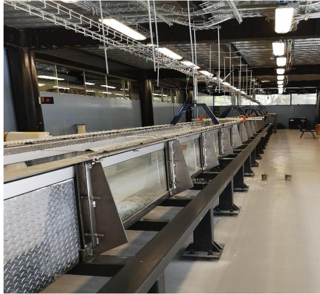
Figura 5. Canal de oleaje e instrumentos que lo componen.
