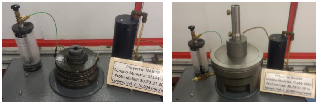
Figura 3.4 Esquema de montaje y fijación del domo
