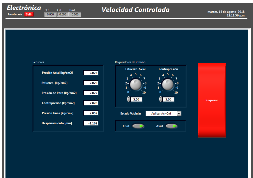
Figura 2.32 Módulo de operación (verificación cruzada)
