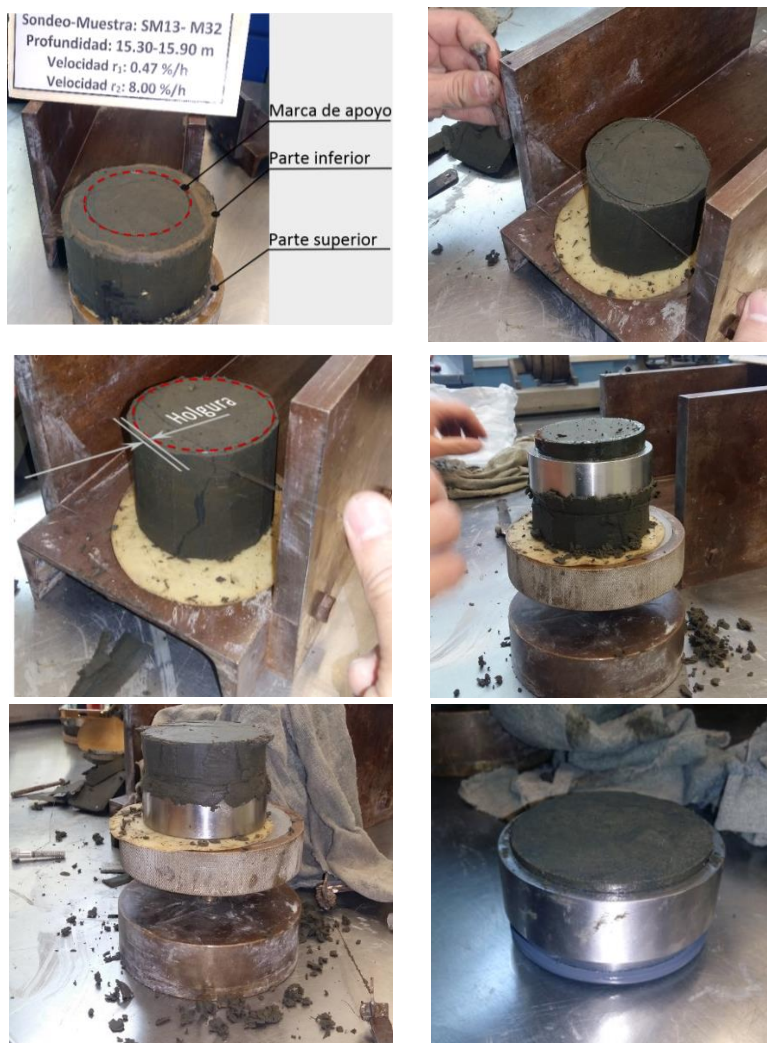
Figura 3.2 Proceso de labrado de la muestra
