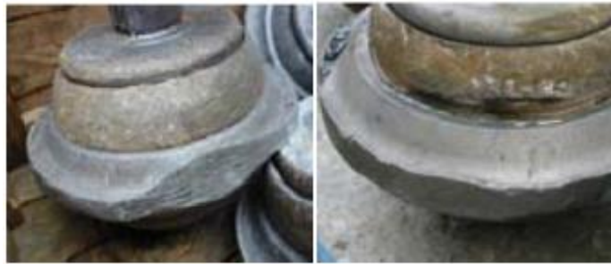
Figura 3.13 Desgaste plano y multiplano en discos de corte. (Hongsu et al., 2007)
