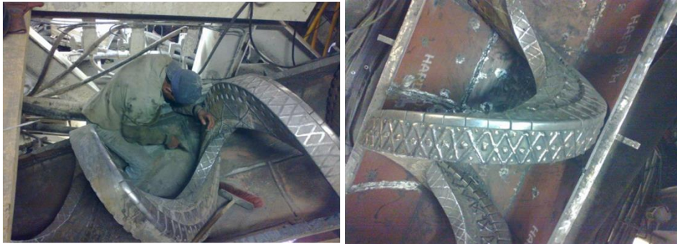
Figura 3.14 Mantenimiento por desgaste del tornillo sinfín (COMISAA,2017).
