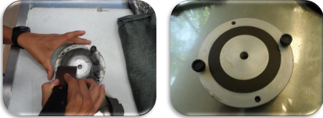
Figura 40. Enrasado de la muestra.
