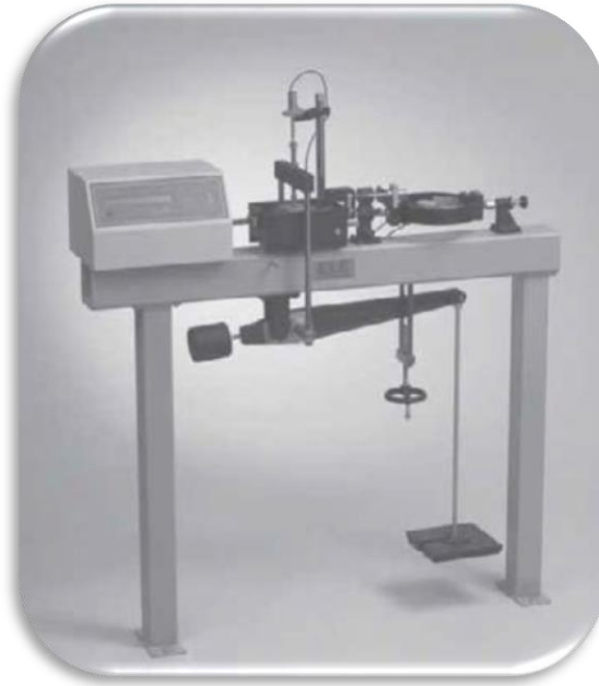
Figura 3. Equipo de prueba de corte directo, Braja M. Das, 1985 (Fundamentos de la ingeniería geotécnica).
