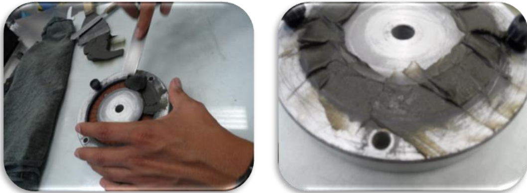
Figura 39. Colocación del suelo en el plato de carga inferior.
