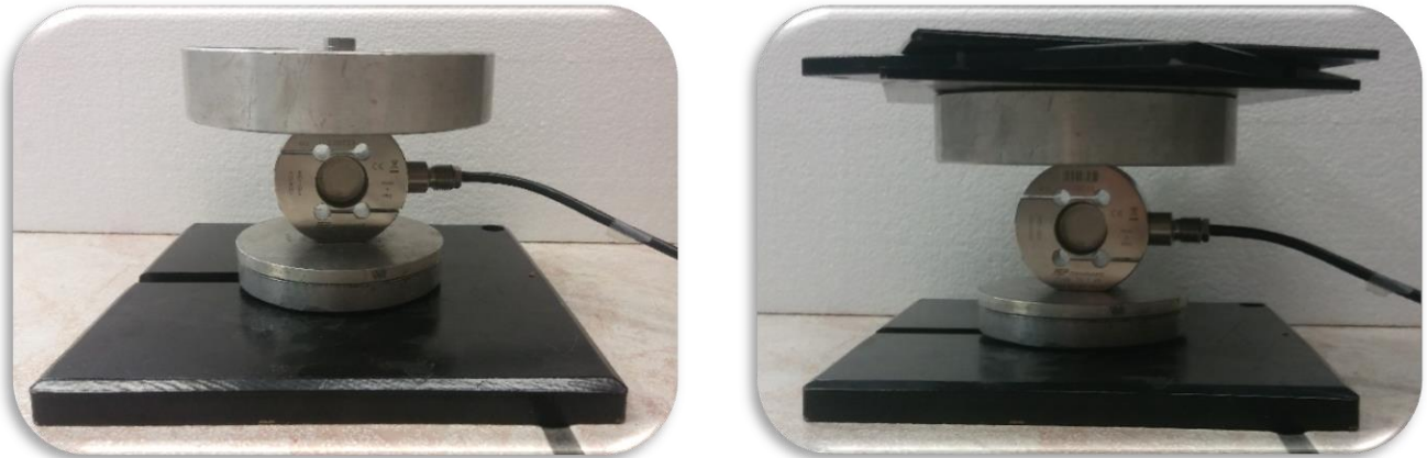
Figura 29. Calibración de celda de carga utilizando como unidad de patrón masas conocidas.
