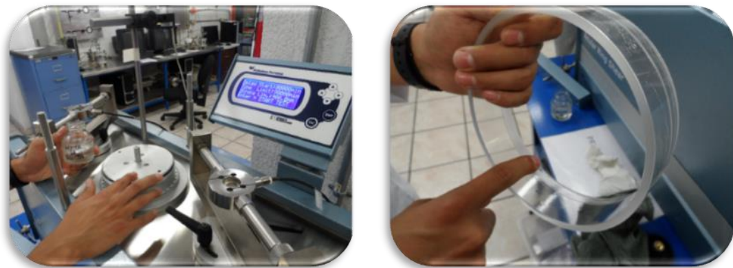
Figura 42. Lubricación con aceite de silicón.
