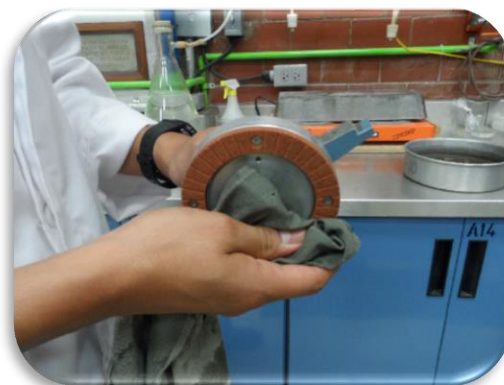
Figura 37. Secado superficial de la piedra porosa.
