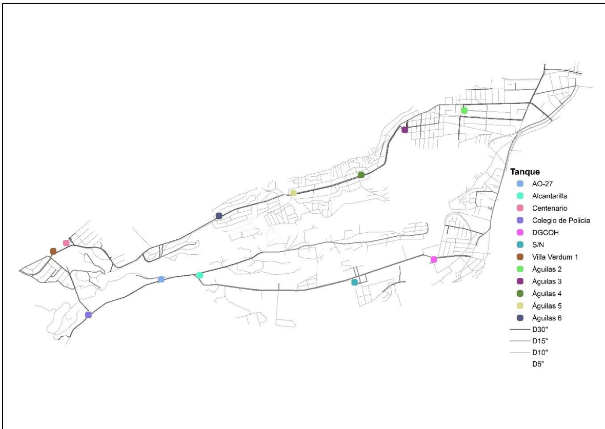
Figura 3: Se muestra la distribución de la red secundaria y sus diámetros, así como la localización de tanques.
