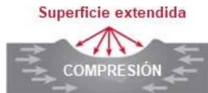
Figura 2.10. Superficie después del disparo de un perdigón por SP. (Lundberg, 2013)
