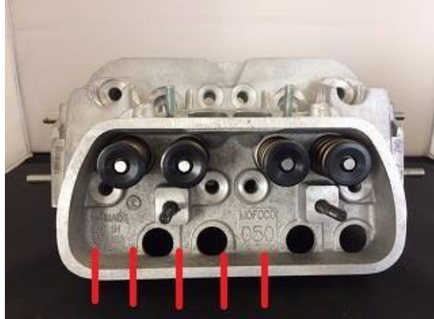
Figura 3.10. Sección de cortes realizados para obtención de probetas.
