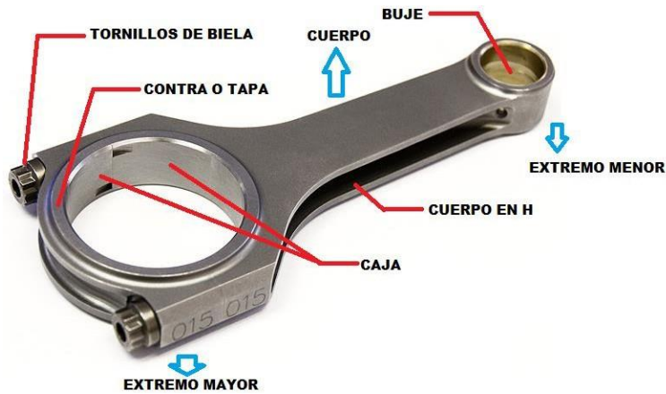
Figura 1.7. Partes de la biela (rojo) y secciones (azul) ( https://www.z1motorsports.com/images/BrianCrowerRodVQ35DEVQ35HR.jpg ).
