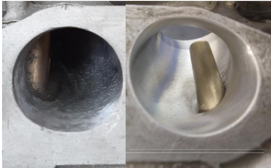
Figura 3.5. Puerto de admisión original ( izq. ), puerto de admisión modificado ( der. ). Se muestra el aumento de volumen del puerto (zona superior del puerto donde puede verse al exterior del mismo), la ampliación del radio corto (mayor curvatura) y el espacio extra de área al lado de la guía de válvula por la remoción de material.
