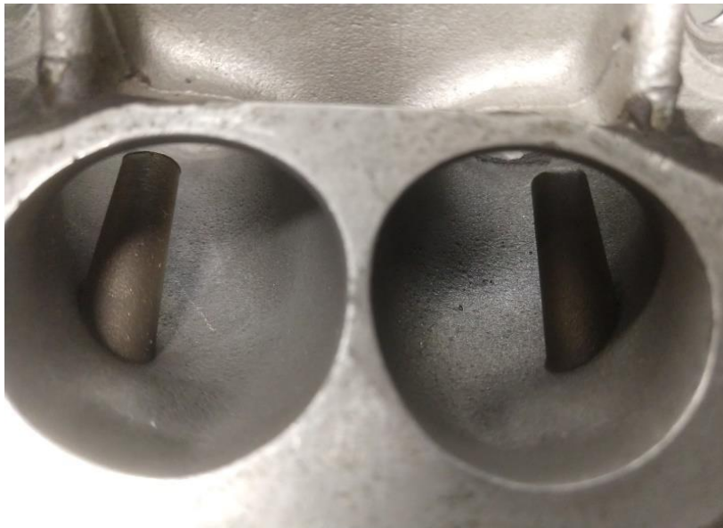
Figura 3.8. Puerto izquierdo (3) con el acabado superficial dejado después del tratamiento de Sand blast . Puerto derecho (4) con el acabado después del proceso de Shot peened .
