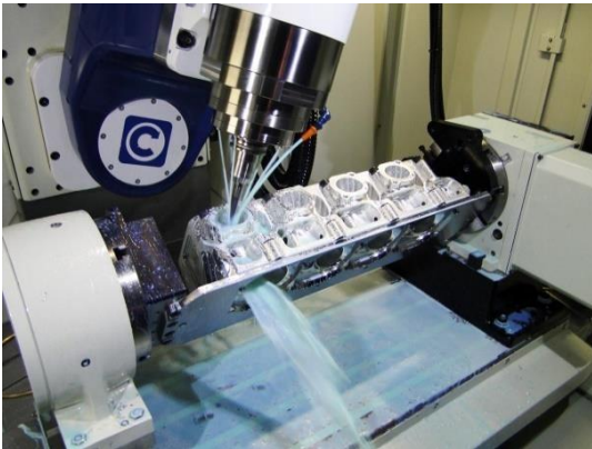
Figura 2.5. a) Proceso de fabricación CNC de una cabeza de cilindros ( http://www.centroidcnc.com/images/cnc_cylinder/2013_a560_1200.jpg ). b) Acabado superficial de un puerto de admisión de una cabeza de cilindros posterior a un proceso de fabricación por CNC. ( http://thitek.net/wp-content/gallery/bare-cnc-ported/bare-cnc-004.jpg ).
