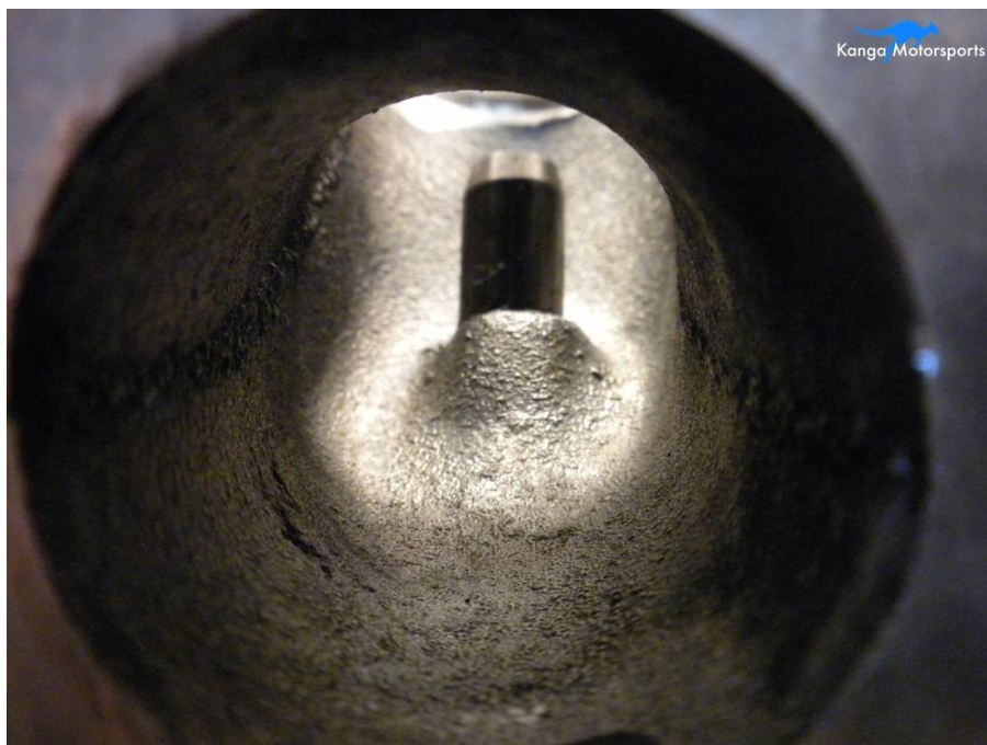
Figura 2.3. Acabado de un puerto de admisión original de Datsun ® después del proceso de fundición.
