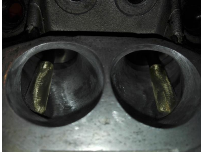
Figura 3.4. Puertos de admisión después del proceso de porteado y previo a pulido.
