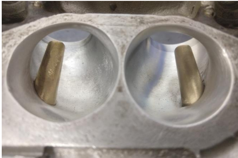
Figura 3.9. Izq. , puerto con acabado normal (dejado por lija 120). Der. , puerto con acabado espejo. Se puede observar una ligera disminución de imperfecciones al interior del puerto.
