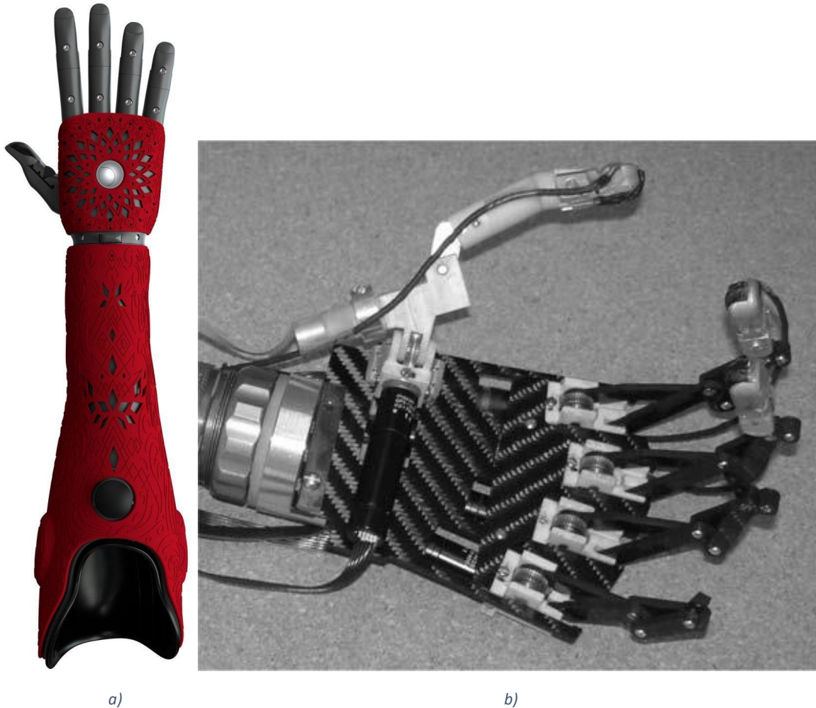
Figura 1.5. Ejemplo de manos protésicas. a) Hero Arm [15]. b) Southampton – Remedi Hand [16].
