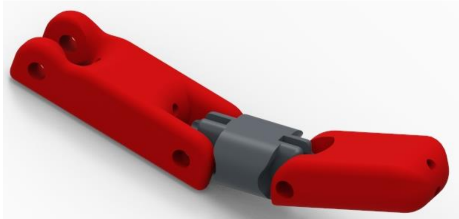
Figura 3.20. Forma final del dedo en CAD.
