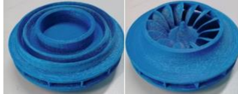
FIGURA 3.3 El rotor ya impreso.
