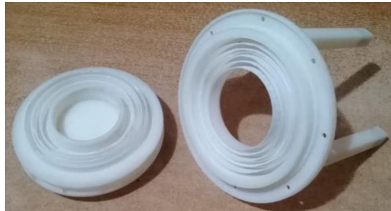
FIGURA 4.12 Nuevo rotor con sello de laberinto de 10 pasos y su contrasello en la tapa de la voluta, ya impresos.
