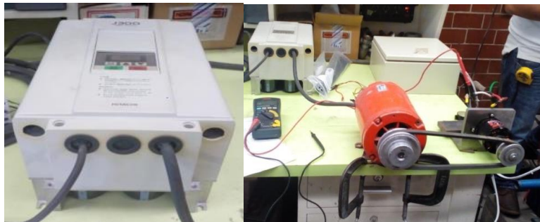
FIGURA 3.22 Inversor Hitachi J300-075LGFU, motor Turnigy conectado al otro motor mediante un sistema de bandas y poleas [1].
