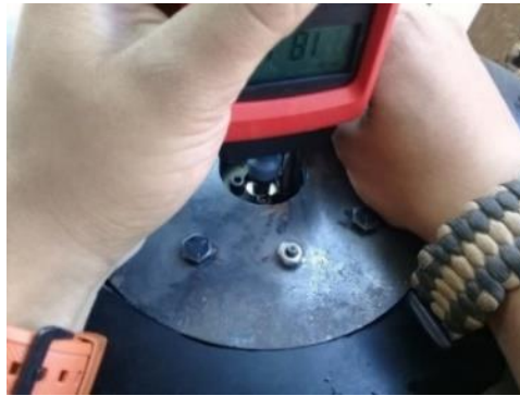
FIGURA 4.6 Medición de las revoluciones por minuto de la turbina.
