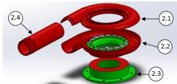
FIGURA 3.4 Voluta dividida en cuatro partes.
