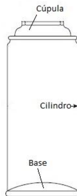
Figura 1.2 Partes de una lata de aerosol.
