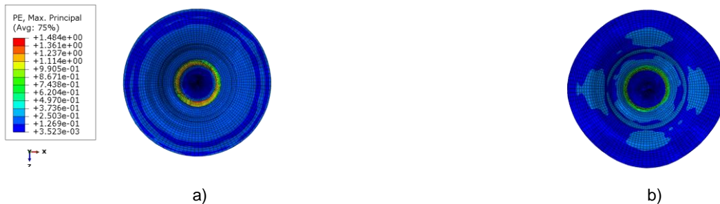
Figura 4.44. Deformación plástica cuarto paso a) isotrópico b) anisotrópico
