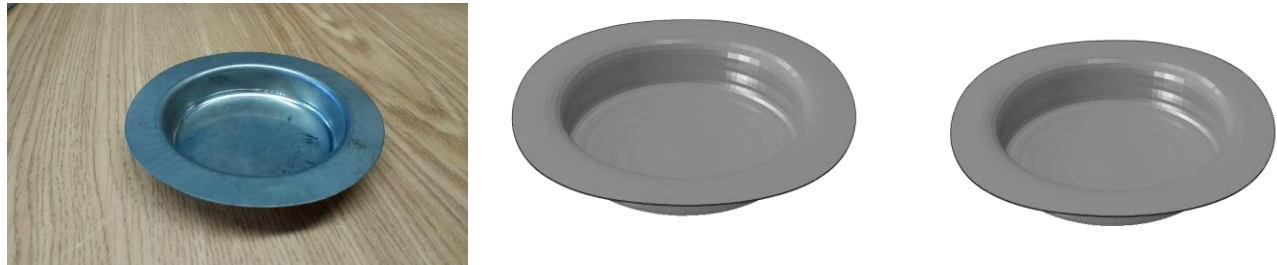
a) b) c) Figura 4.9 Primer paso de embutido a) Real b) Con lámina isotrópica c) Con lámina anisotrópica
