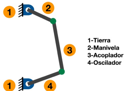
Figura 3.16. Números asignados a los eslabones para el análisis MO4-2.
