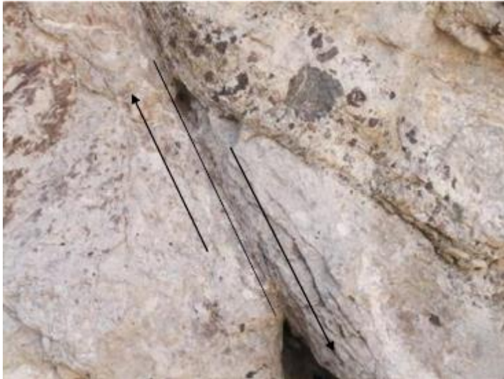
Figura 10, Plano de falla con fracturamiento intenso, roca triturada y una delgada capa de sílice recrystalizada
