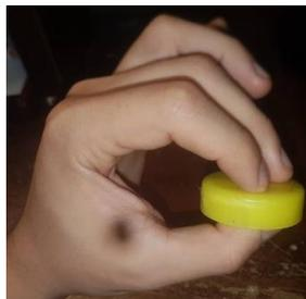
*Figura 42: Ejemplo de cómo sostener el disco instrumentado con la prótesis en presión trípode.*
