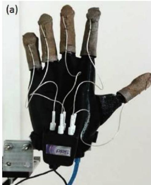
Figura 22: Sensores táctiles montados en la prótesis (Ahmad Yaser Alhaddad, 2017).
