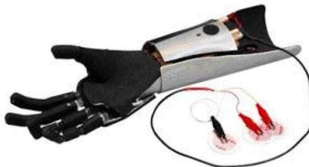
*Figura 5: Prótesis bioeléctrica con sus respectivos electrodos (Fisioterapia, 2013).*
