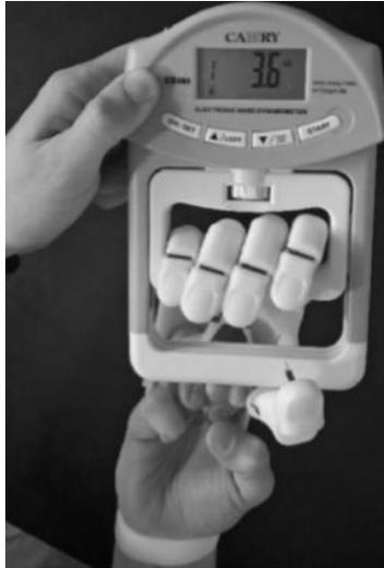
Figura 44: Ejemplo de cómo agarrar el dinamómetro con la prótesis (Harris, 2017).
