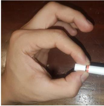
Figura 46: Ejemplo de sujeción del cilindro con la prótesis en prensión de precisión.
