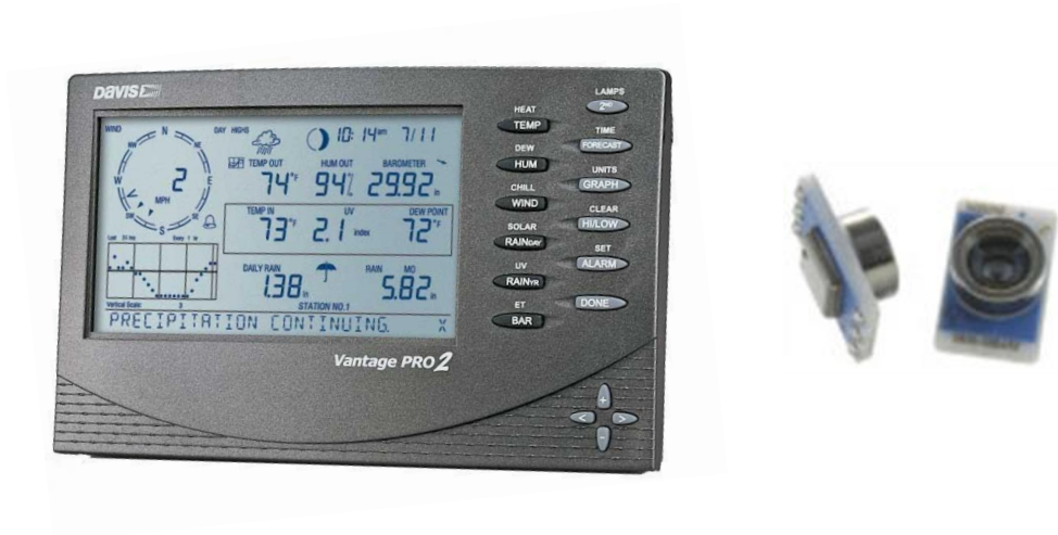
Figura 1.14. Estación Davis Vantage Pro 2 y su sensor de presión mostrado a gran escala.
