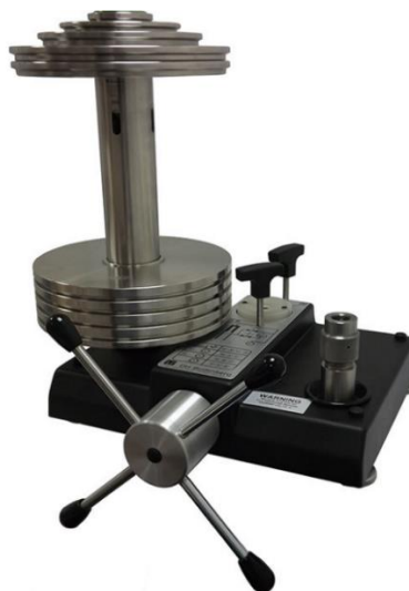
Figura 1.17. Una balanza de pesos muertos puede generar presiones con un alto grado de precisión gracias al fino ajuste de la masa con que se fabrican sus pesas.
