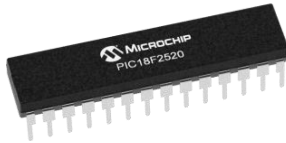
Figura 3.2. Apariencia física del PIC18F2520.
