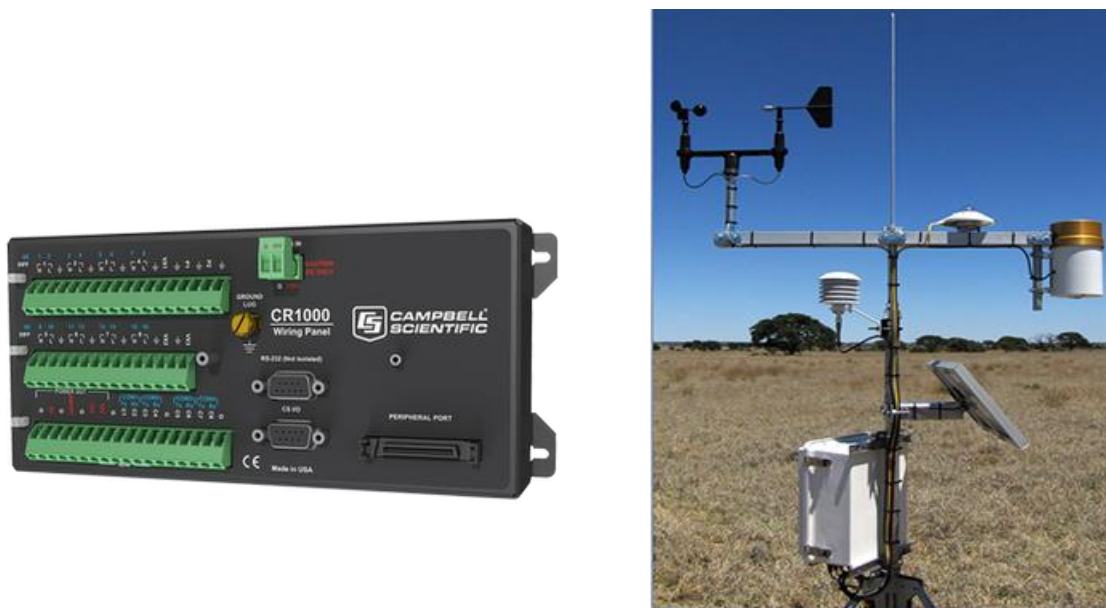
Figura 1.7. Ejemplo de estación meteorológica automática y un adquisidor de datos CR1000 de Campbell Scientific .
