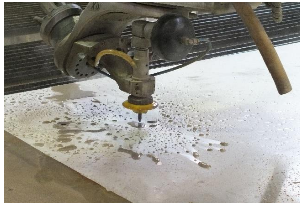
Figura 2.5. Proceso de corte por chorro de agua.
