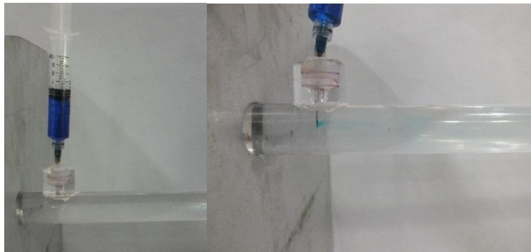
Figura 4.1. Inyección de colorante en el primer puerto.
