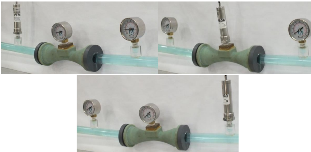
Figura 3.7. Tubo de Venturi con el transductor de presión en las tres tomas de presión.
