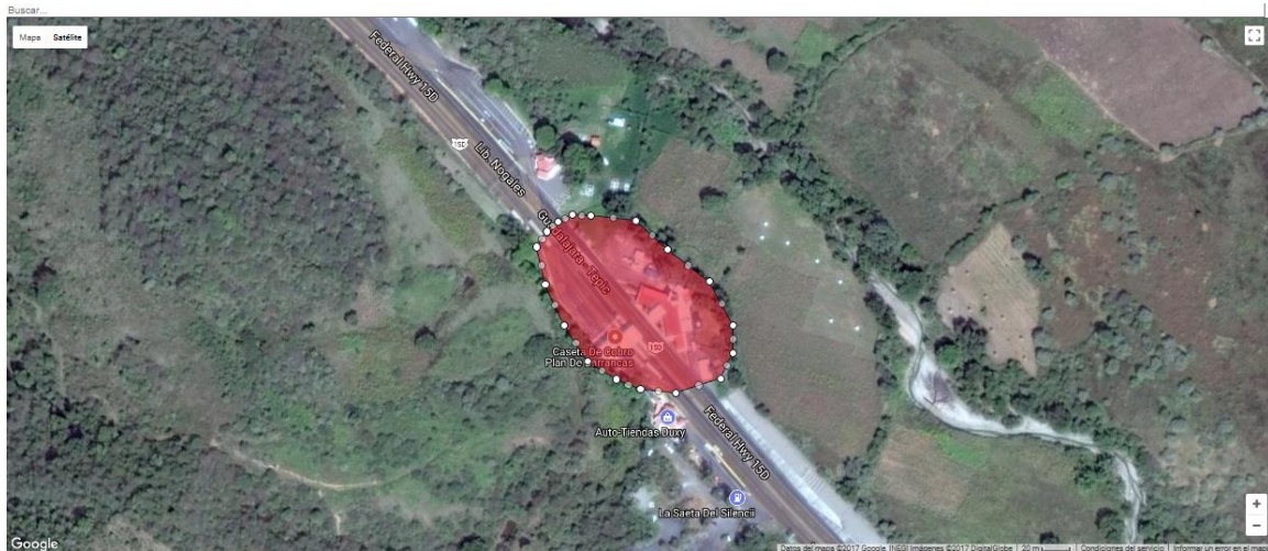
Figura 22: Geocerca de polígono en caseta de cobro Plan de Barrancas (Autopista Guadalajara – Tepic)
