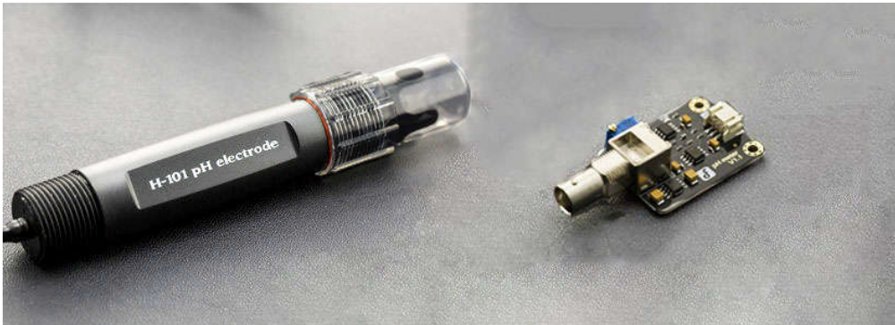
Figura 9-9 Fotografías del electrodo de pH FIT0348(derecha) y la placa de conversión (izquierda) (DFRobot, 2018c).
