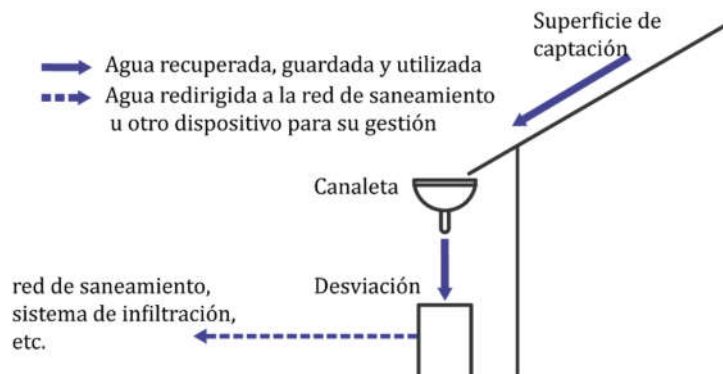
Figura 2-19 Funcionamiento básico de un separador de primeras aguas de lluvia. Adaptado de (Belmeziti, 2012)
