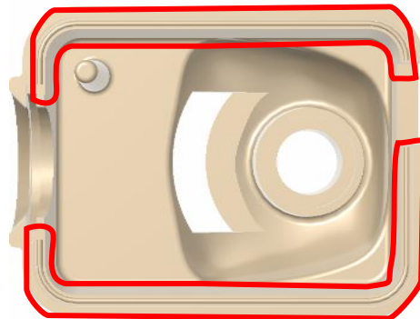
Figura 3.35 Guías de soldadura en la carcasa superior.
