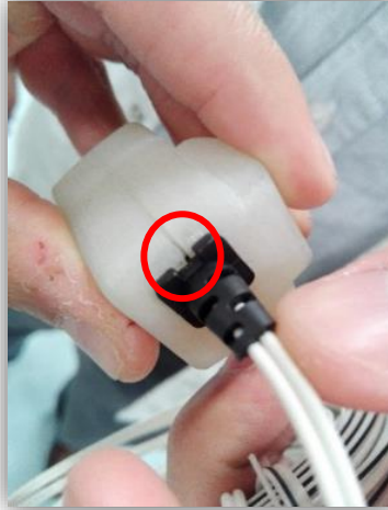
Figura 3.5 Aliviador de tensión ensamblado a un prototipo.
