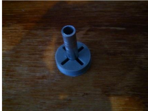
Imagen 11: Se muestran diseño del sistema de sujeción impreso en 3D, el tubo simula el eje de motor.
