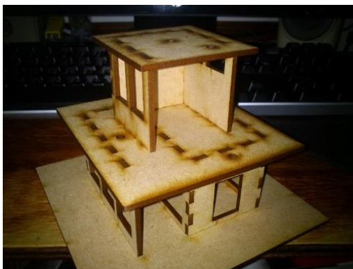
Imagen 8: Se muestra el primer diseño de prototipo, manufacturado en MDF de 3 mm, con corte láser (der.)
