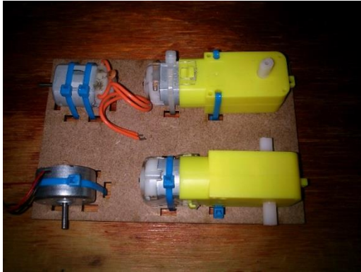
Imágenes 9 y 10: Se muestran diferentes formas de sujeción por medio de “cinchos”
