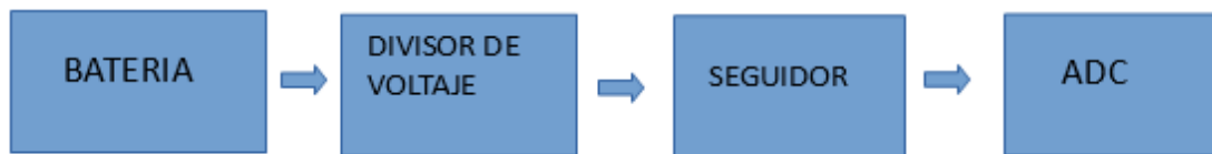
Figura 2.13 Diagrama de bloques de censado de voltaje
