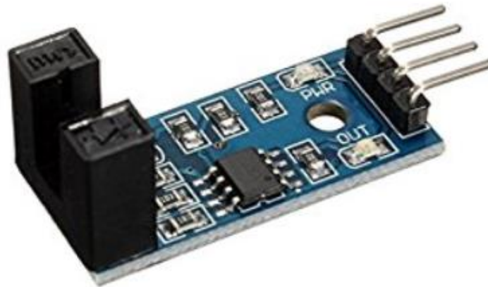
Figura 2.5 Shield con opto-interruptor
