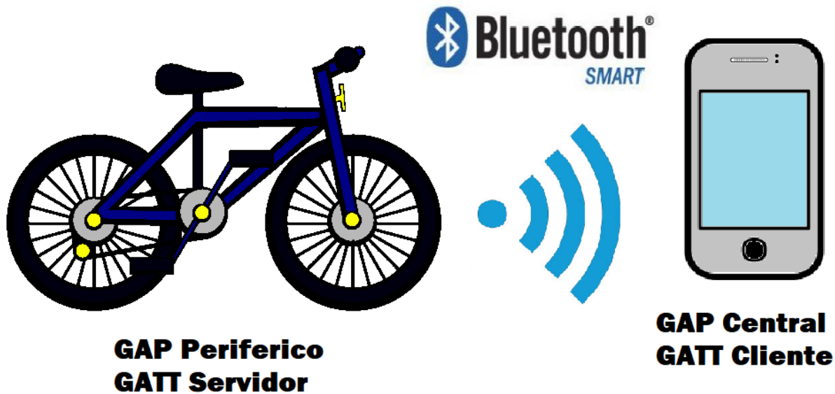
Figura 3.2 Topología BLE entre BE y teléfono móvil
