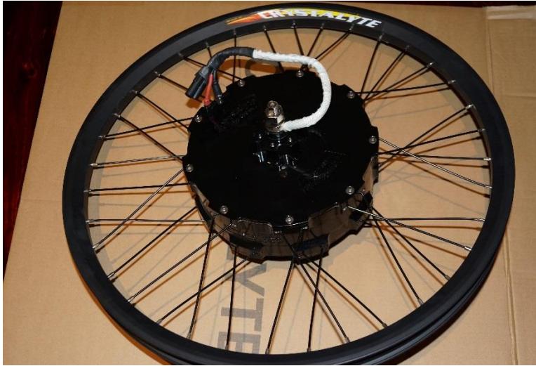
Figura 1.3 Motor BLDC montado en rueda (HUB)
