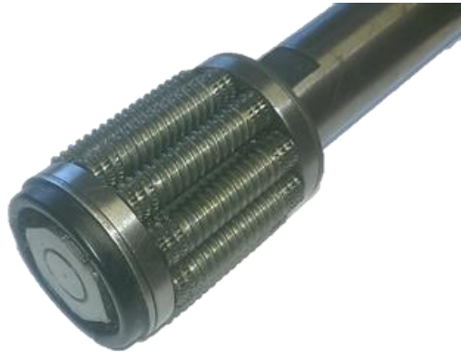
Figura 1.2. Foto del tornillo impulsor de rodillos del prototipo actual del RTICR.
