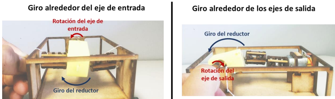
Figura D.4. Giros en el reductor cuando el eje de entrada rota en sentido horario.
