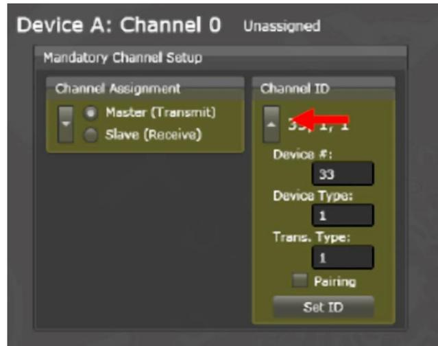
Figura 4.31 Configuración de la ID de canal en PC1.
