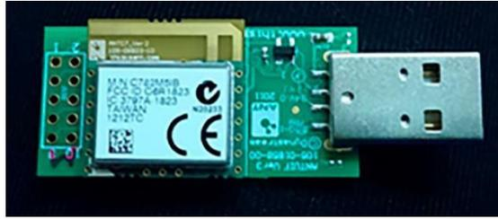
Figura 2.10 Tarjeta USB con módulo C7.
