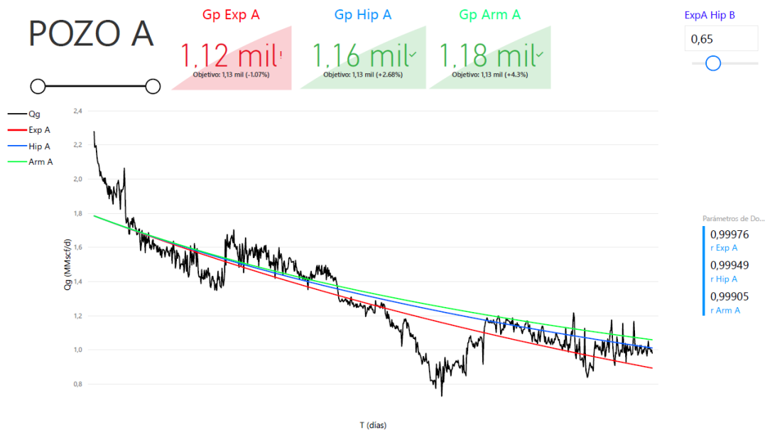
FIGURA 4. 4 ANÁLISIS DE CURVAS DE DECLINACIÓN DEL POZO A MEDIANTE LOS MÉTODOS DE ARPS EXPONENCIAL, HIPERBÓLICO Y ARMÓNICO.
