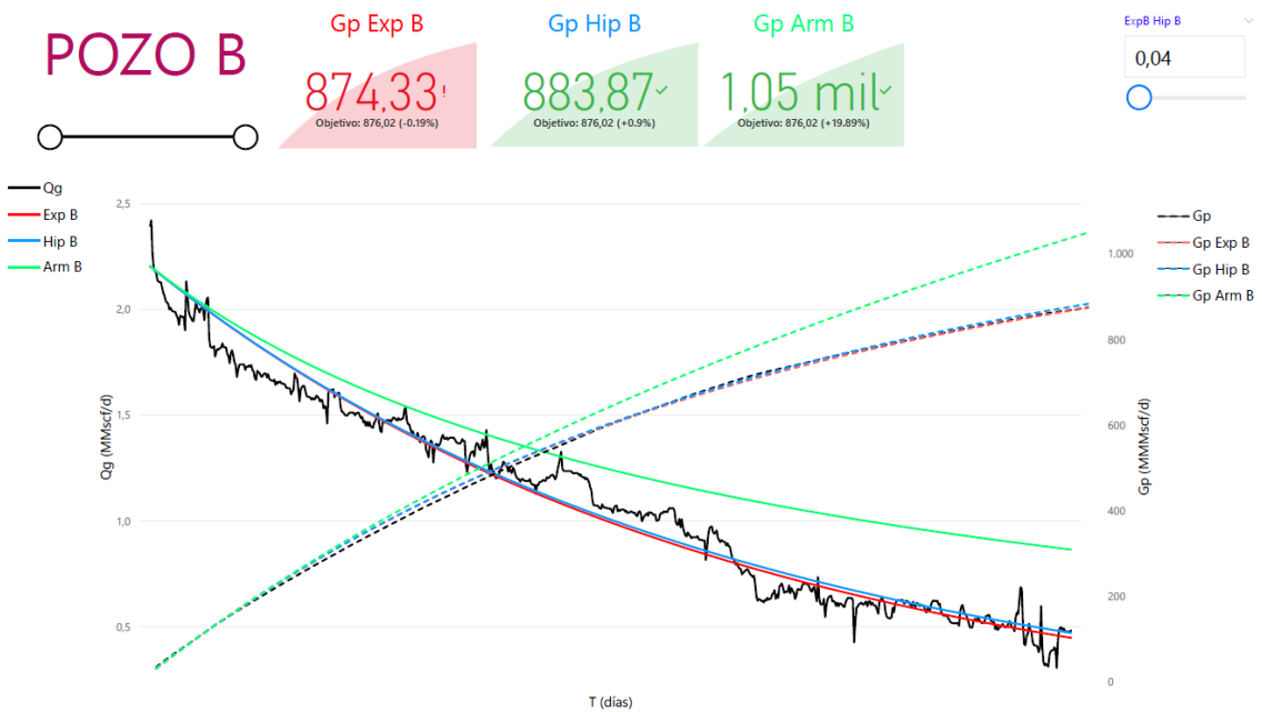
FIGURA 4. 13 ANÁLISIS DE CURVAS DE DECLINACIÓN Y PRODUCCIÓN ACUMULADA DEL POZO B MEDIANTE LOS MÉTODOS DE ARPS EXPONENCIAL, HIPERBÓLICO Y ARMÓNICO.
