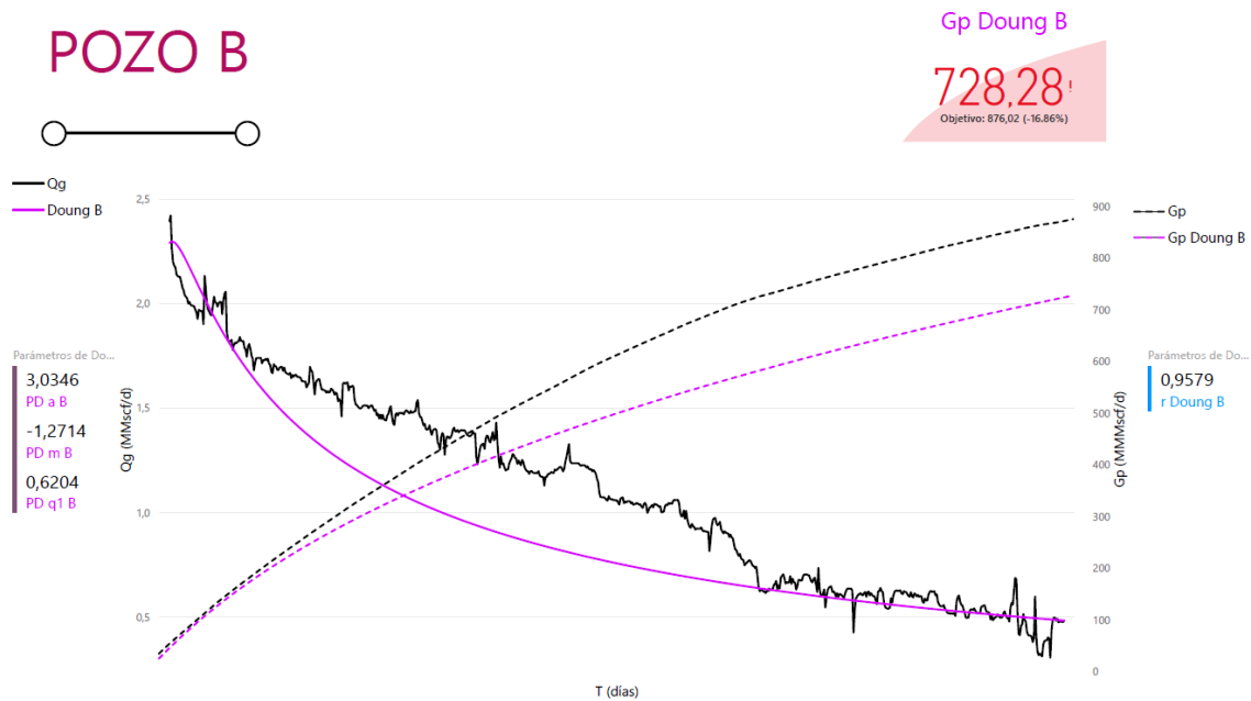
FIGURA 4. 15 ANÁLISIS DE CURVAS DE DECLINACIÓN Y PRODUCCIÓN ACUMULADA DEL POZO B MEDIANTE EL MÉTODO DE DOUNG.
