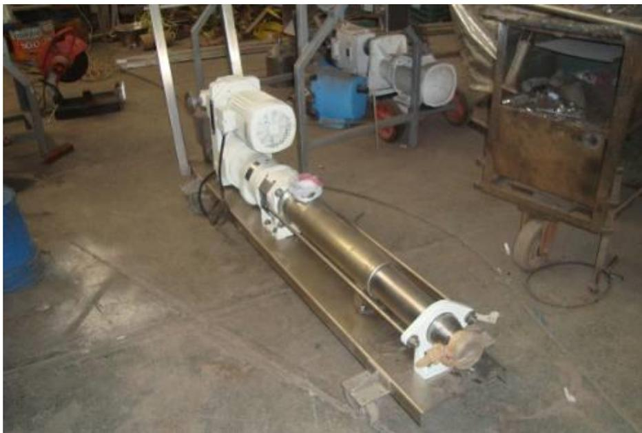
*Figura 9. Bomba de inyección marca Moyno. (Moyno, s.f.)*
