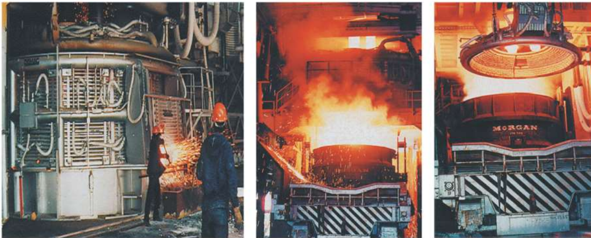
Figura 2.2 Flujo del proceso de acería: horno de fusión, horno de afinación y vaciado del acero, respectivamente (Pemex).
