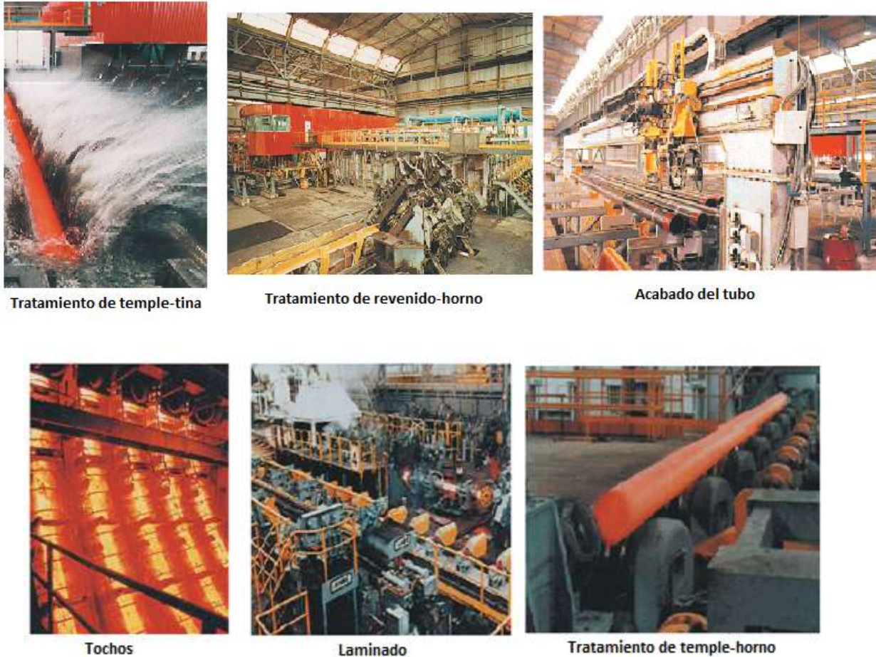
Figura 2.3 Proceso de fabricación sin costura (Pemex). Modificado.
