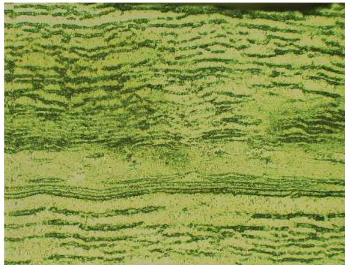
Figura 3.8 Productos de corrosión en un ambiente combinado con múltiples capas de compuestos de sulfuro de hierro (Choi & Al-Ajwad, 2008).
