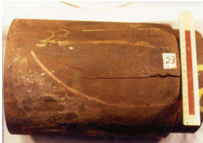
Figura 1.7 Stress Corrosion Cracking en una tubería petrolera (Rosas, 2019).
