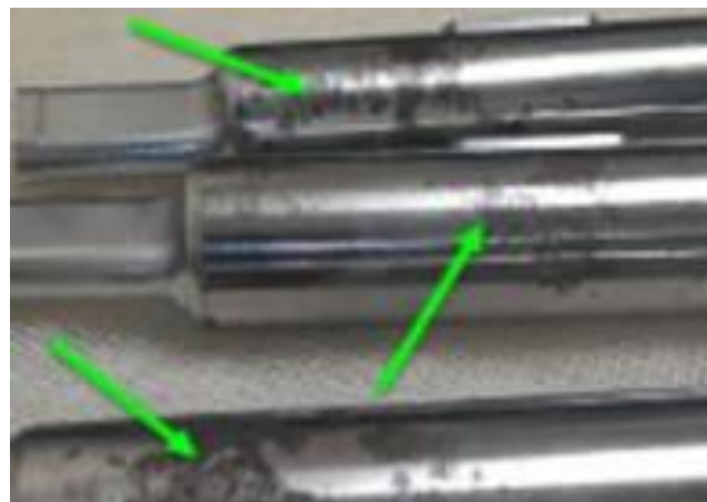
Figura 3.3 Visualización de óxido en el cuerpo de los punzones
