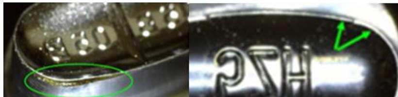
Figura 3.2 Puntas de punzones con pérdida de material
