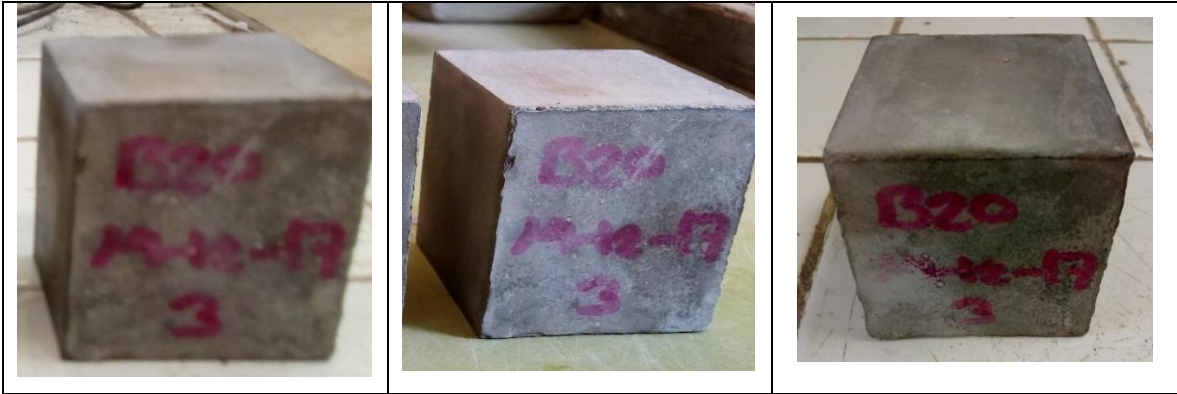
Figura 3.16 Pasta RCD-M200-20 en solución de sulfato de sodio.
