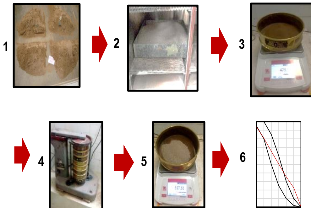
Figura 2.1 Proceso para la obtención de la curva granulométrica de los RCD-M. 1) Cuarteo; 2) Secado al horno durante 24 h a 110°C ± 10°C; 3) Obtención del peso de los tamices; 4) Cribado mecánico; 5) Peso del material retenido en cada tamiz; 6) Cálculo de la curva.
