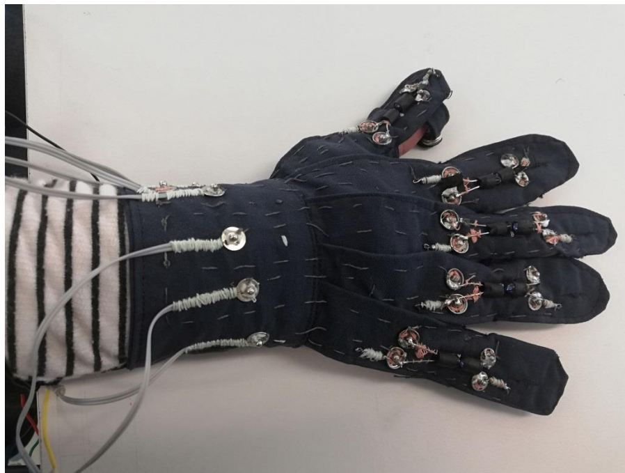
Figura 57. Fotografía del guante puesto en un sujeto de prueba, se pueden observar los sensores y el hilo conductivo formando parte del circuito.
