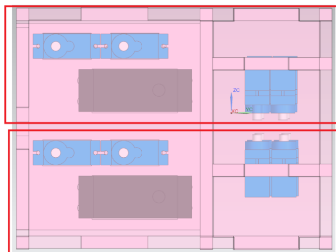
Figura 48. Muestra de los dos pisos en los que se encuentran los actuadores.
