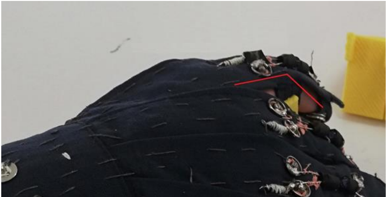
Figura 61. Fotografía del guante de sensado donde se ilustra el ángulo que se forma entre la falange proximal y media correspondiente al ángulo que puede medir por medio de los sensores.
