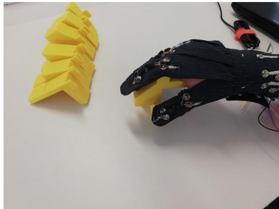
Figura 85. Mano de sujeto de prueba con el guante puesto usando los moldes para calibrar.
