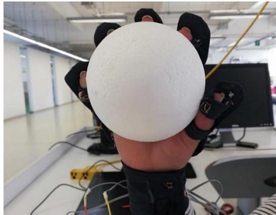
Figura 80. Sujeto de pruebas sosteniendo una pelota de grandes proporciones con respecto a su mano con el guante puesto.
