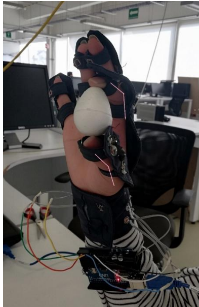
Figura 82. Sujeto de prueba sosteniendo un huevo. Los cambios de grado son nuevamente medibles por el guante de sensado y los ángulos con mayor cambio en este movimiento de sujeción se pueden apreciar en la imagen.
