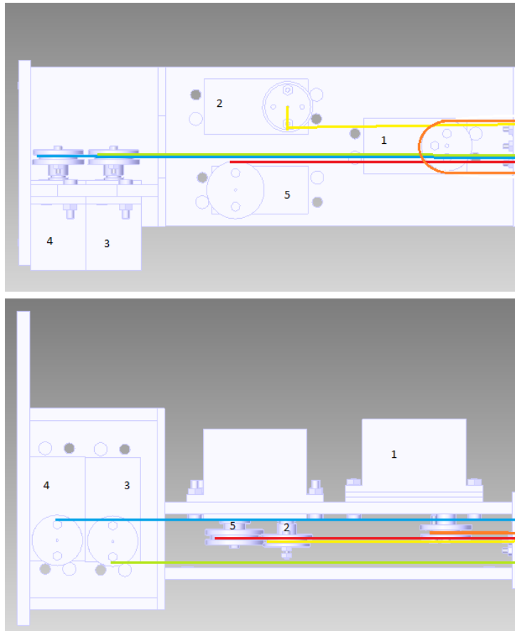
Figura 46. Se muestra la disposición de los tendones en la base de los actuadores, se puede observar que en la disposición original los tendones no se tocan entre sí, impidiendo interferencias.
