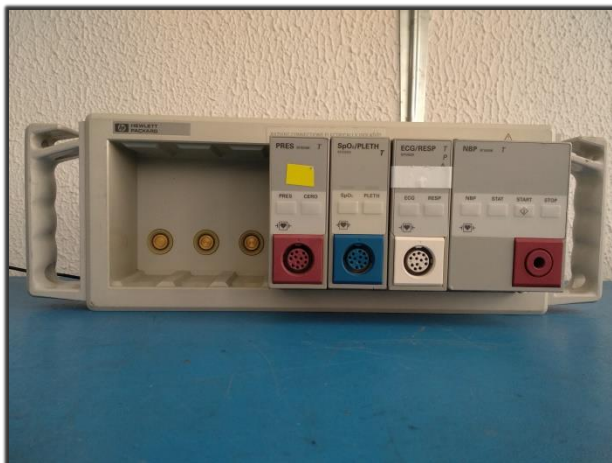
Figura 4. Rack uniparamétrico del monitor de signos vitales modular HP Viridia 24CT (Fotografía tomada por el autor)
