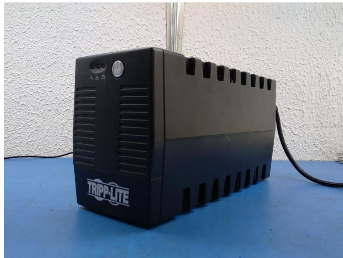
Figura 32. UPS marca TRIPP.LITE modelo VS800AVR utilizado para el respaldo de energía de la central (Fotografía tomada por el autor).
