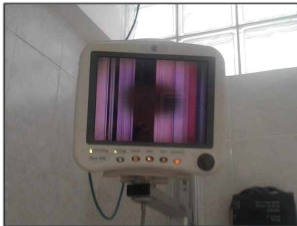
Figura 8. Falla de display en monitor Dash 4000 (Fotografía tomada por el autor).
