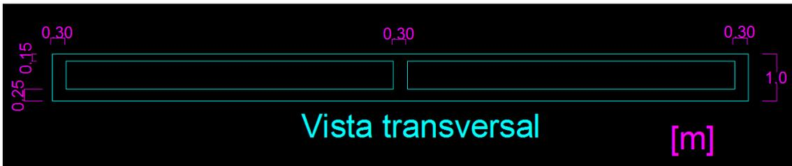
Figura 3. 2 Vista transversal del cajón de cimentación.
