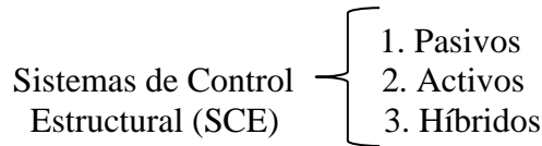
Figura.3. 2. Clasificación de los sistemas de control estructural (Bonilla, 2012)
