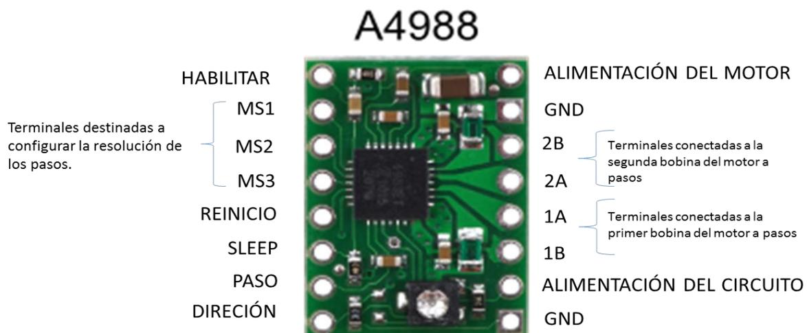
Figura 4.2. Terminales del controlador a4988.
