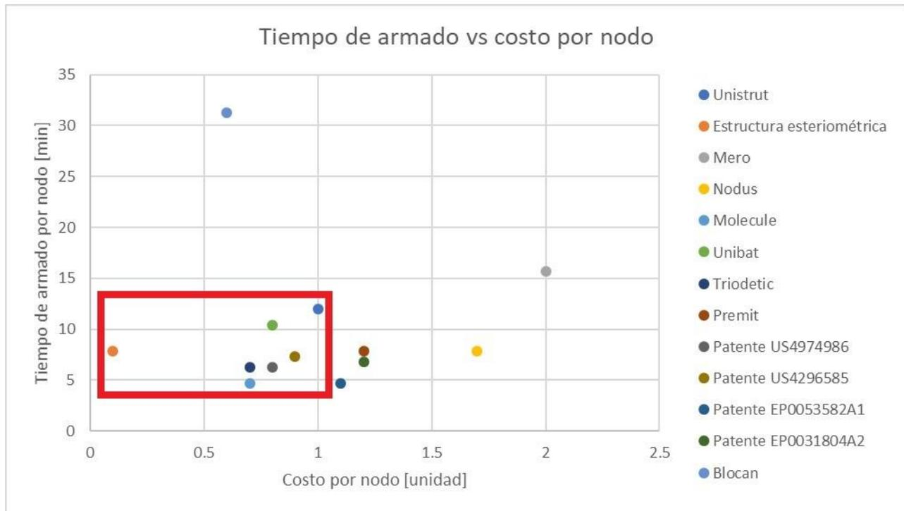
Figura 4-5. Gráfica tiempo de armado vs costo por nodo
