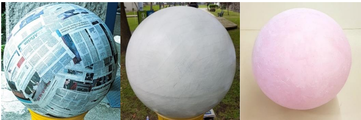
Figura 7-7 Proceso de recubrimiento de la primera esfera.
