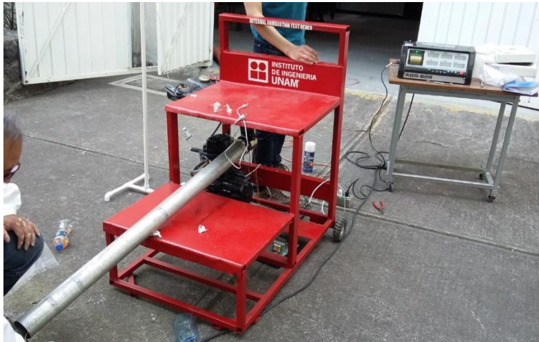
Figura 43. Prueba para medir las concentraciones de los gases con el tubo de dilución.
