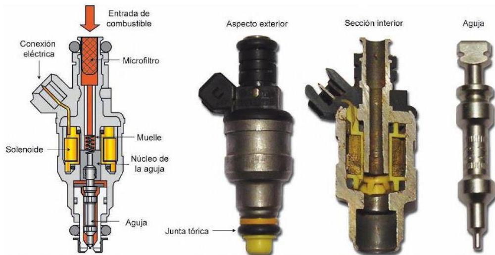
Figura 23. Inyector para un sistema de inyección indirecta multipunto [23].
