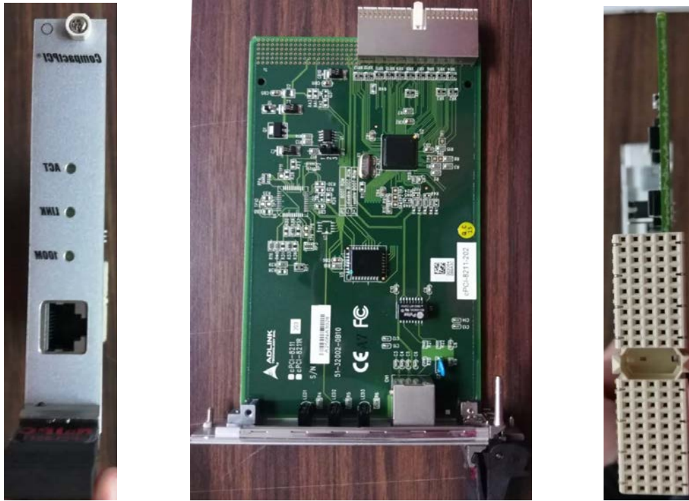
Figura E.- Tarjeta Ethernet 1 puerto. Vista frontal (izquierda), tarjeta electrónica (centro), vista trasera (derecha).
