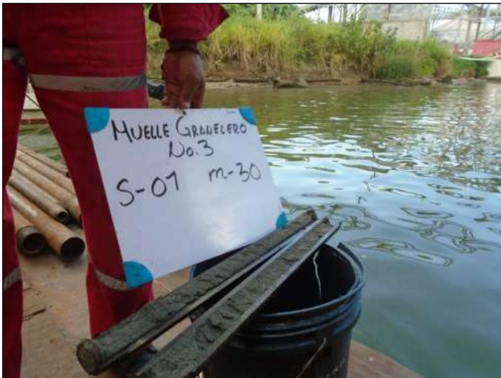
FIG. 42 Muestra Alterada en Tubo Partido (SPT)
