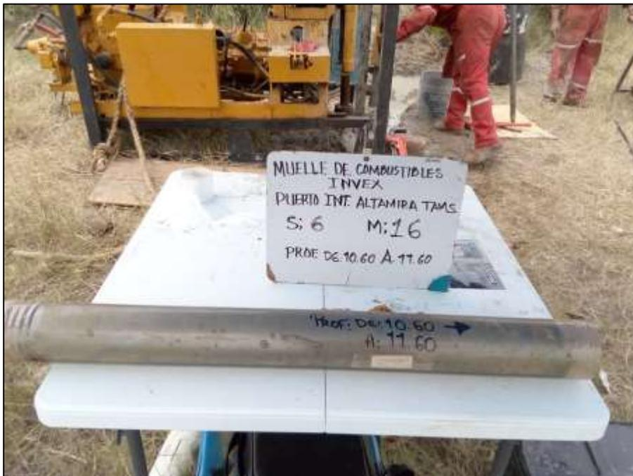
FIG.22 Obtención de muestra inalterada con Tubo Shelby de 4".
