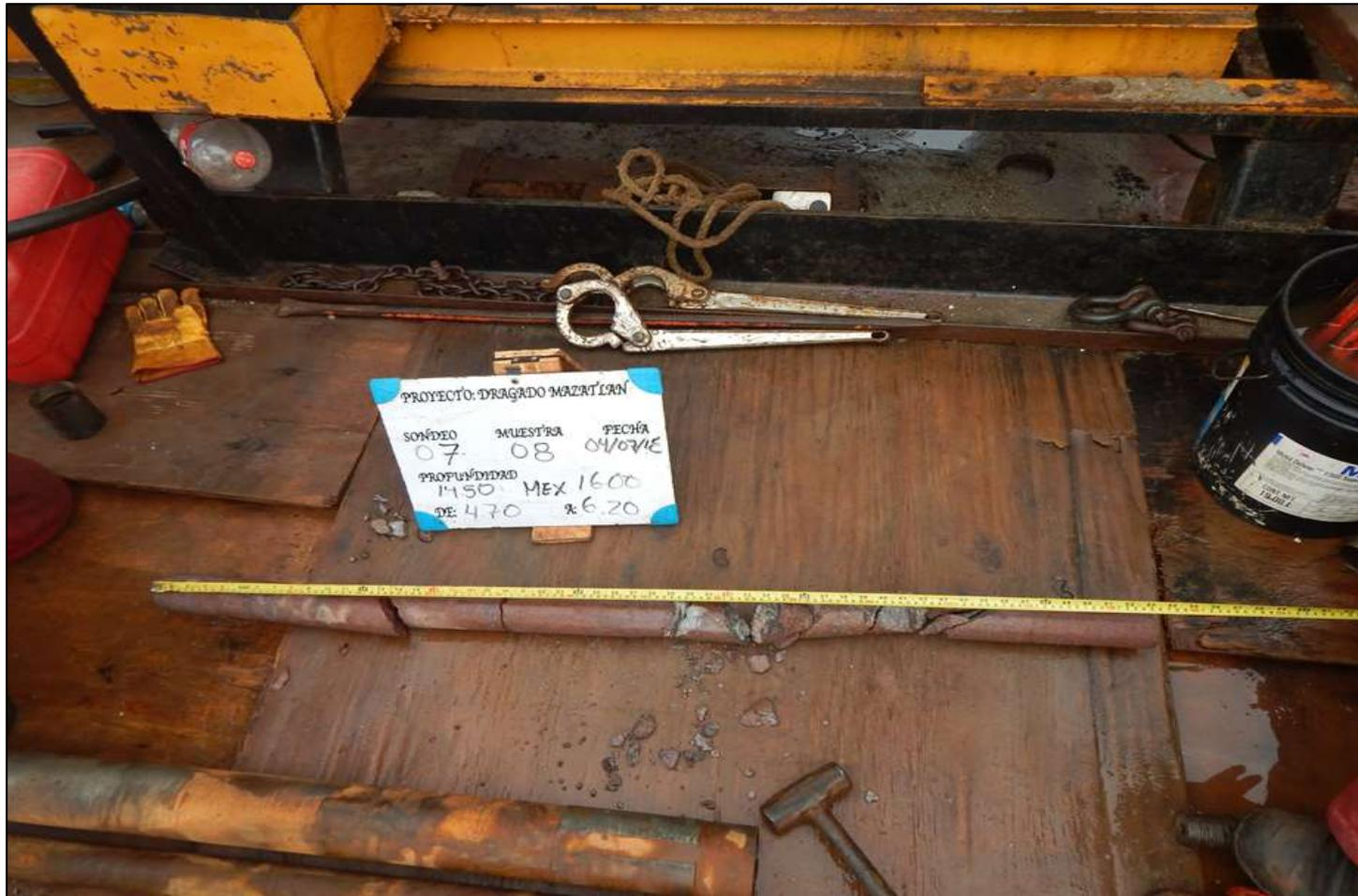
FIG.25 Muestra de Roca con Doble Barril Giratorio HQ. Mazatlán, Sinaloa.
