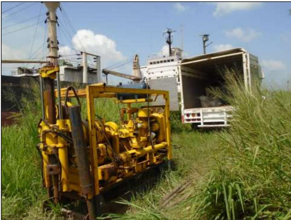
FIG.37 Equipo de Perforación Long Year 34.
