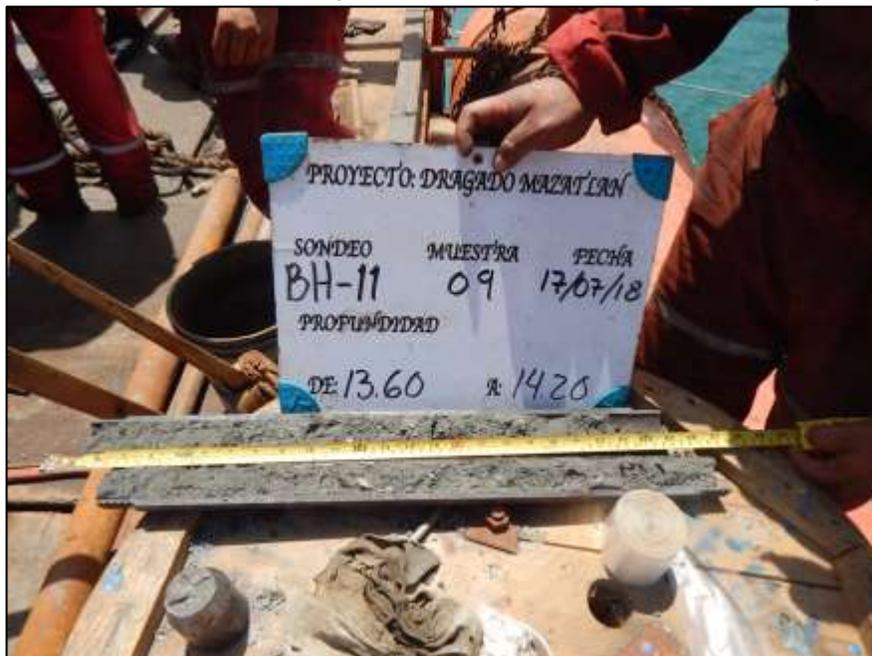
FIG.20 Obtención de muestra alterada con método de Penetración Estándar (SPT). Mazatlán, Sinaloa
