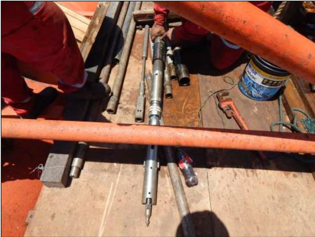
FIG.24 Doble barril giratorio con pescador. Mazatlán, Sinaloa
