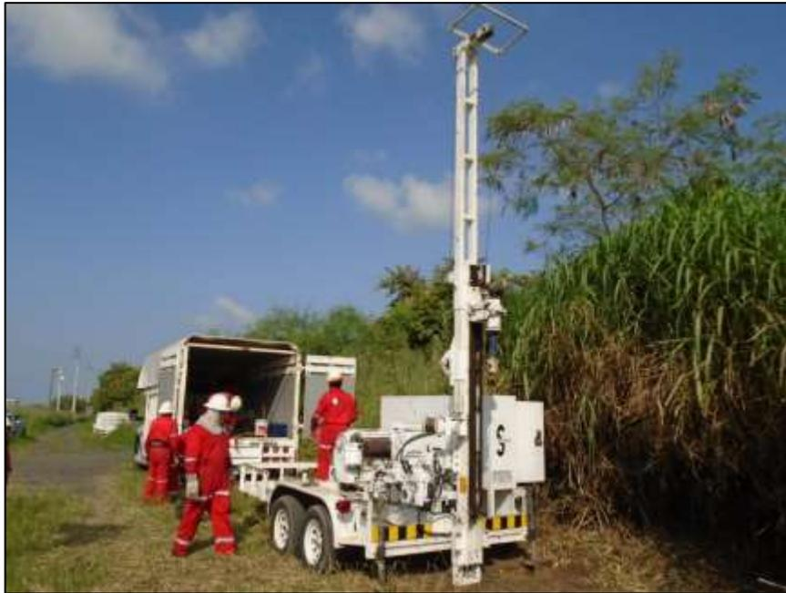
FIG.38 Equipo de Perforación Simco 2400
