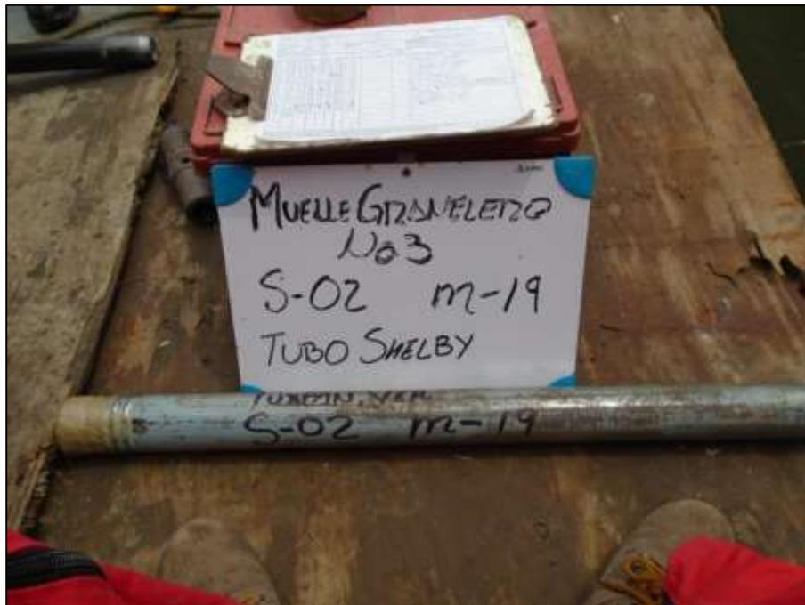
FIG.44 Muestra Inalterada en Tubo Shelby de 2" de diámetro.
