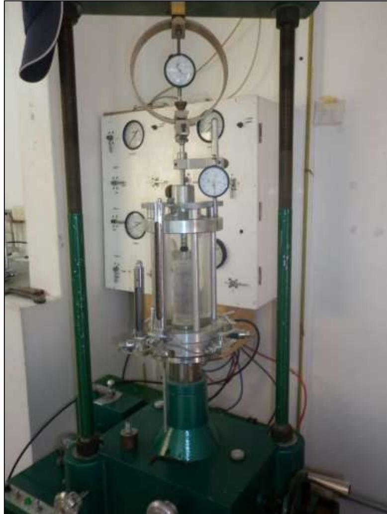
FIG.26 Cámara Triaxial
