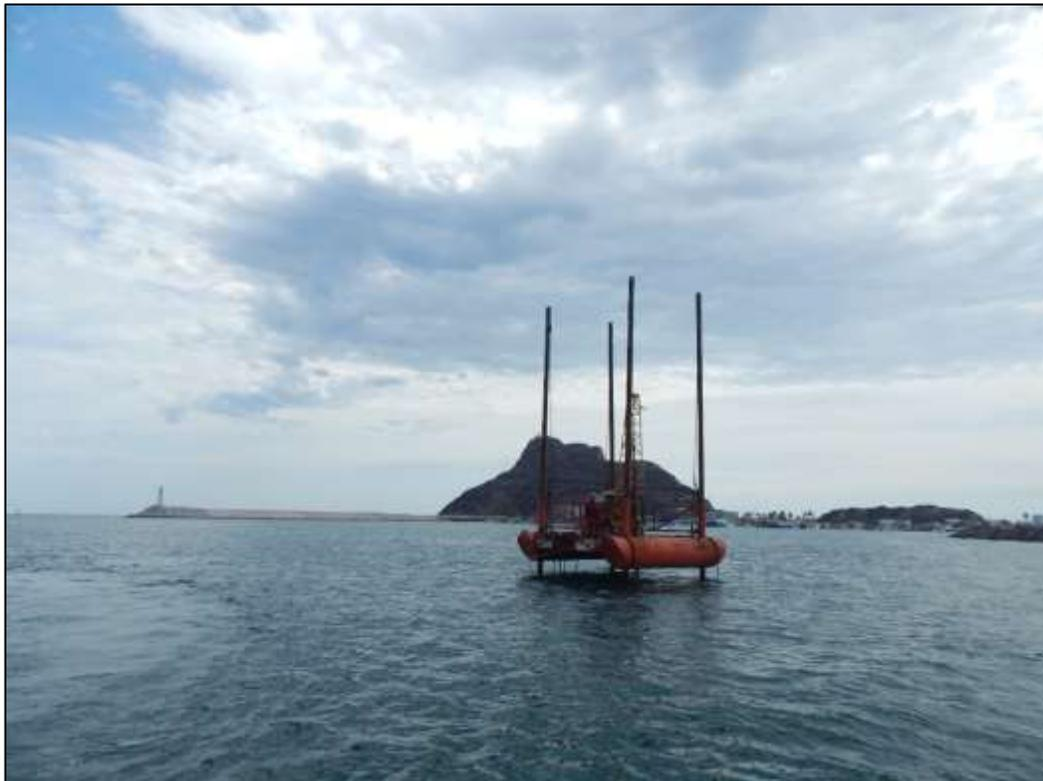
FIG.18 Exploración en el Puerto de Mazatlán, Sinaloa con Plataforma tipo Jack-Up
