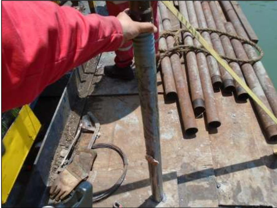
FIG.43 Tubo Shelby o Tubo de Pared Delgada de 2" de diámetro.
