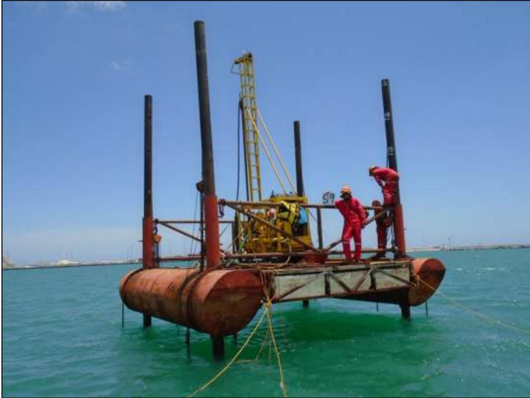
FIG.18 Exploración para efectos de dragado en mar abierto con Plataforma tipo Jack-Up Puerto Progreso, Yucatán.
